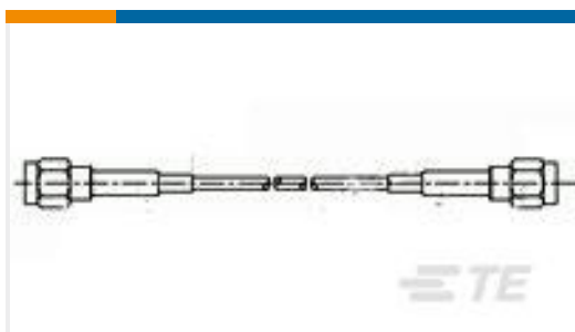
TE 系列/零件编号1337808-3 50 OHM COAX SMA STR PLUG STR P
