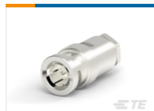
TE 系列/零件编号 1-1478404-0 BNC Str Plg PS 75Ohm Silver RG59B/U, 62A
